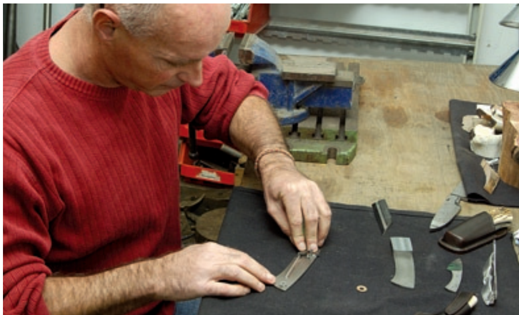
Reiz der Mechanik: Stefan hat das Thema Klappmesser schnell für sich entdeckt. Hier montiert er gerade eine Titan-Platine für einen großen Folder.
