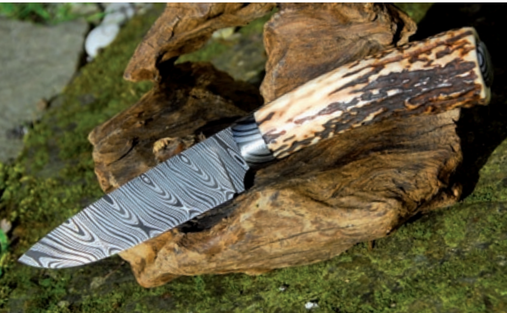
Auftragsarbeit: Jagdmesser aus eigenem, tordiertem Damast und verschraubtem Sambar-Hirschhorngriff.
