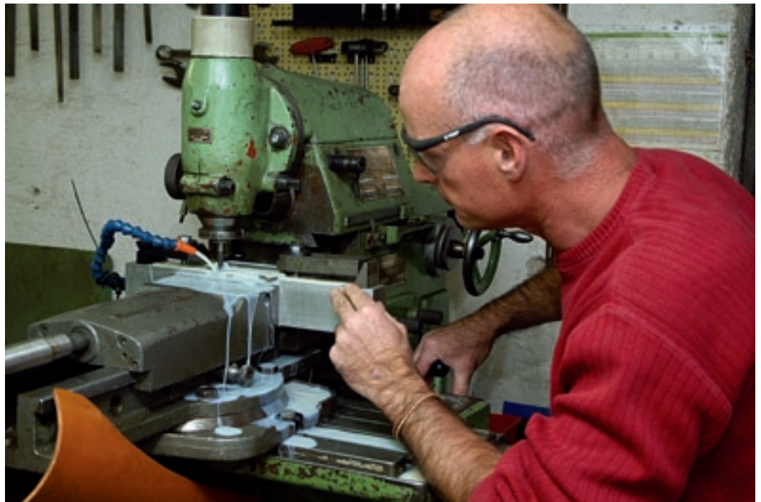
Nichts verlernt: Der gelernte Werkzeugmacher fräst mit einer alten FP-1 die Federtasche in eine Titanplatte.
